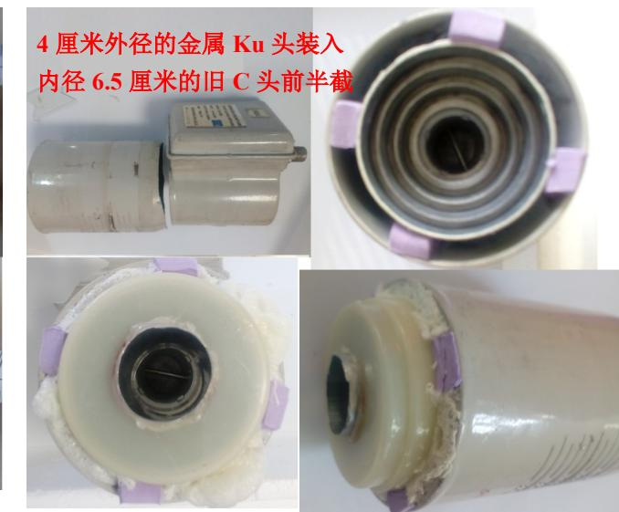
制作好的波导管放入 ku 头后的效果如右图，波导管的长度根据实际情况，不必认为一定是 3.2 厘米长，天线原因，高频头大小各异，可适当裁剪波导管的长度进行调整。
