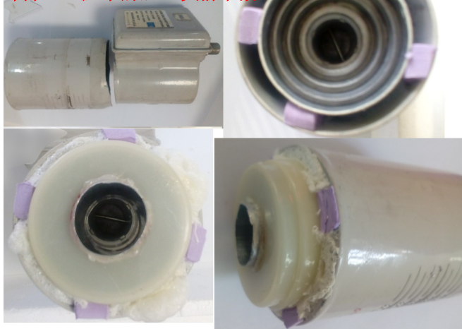
4 厘米外径的金属 Ku 头装入 内径 6.5 厘米的旧 C 头前半截
